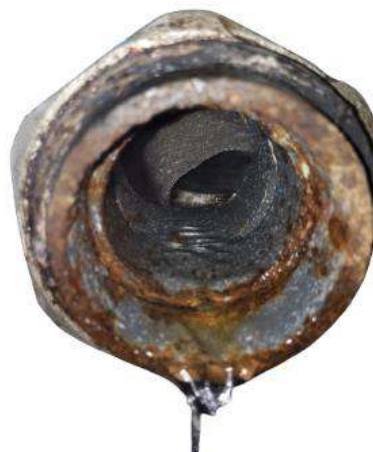
TUBERÍA SIN SARRO, LUEGO DE 6 MESES DE TRATAMIENTO CON DEI
